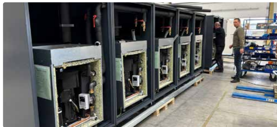
200 kW kaskadeanlæg med miljøvenligt propan gøres færdigt på fabrikken til hurtig installation hos kunden.
